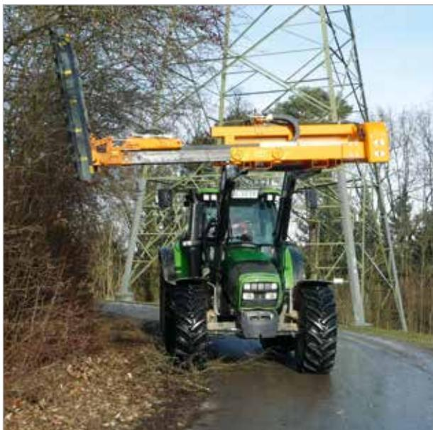
Die angebaute Astschere kann über ein Teleskop ca. 1,20 m verschoben werden.
