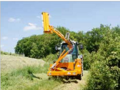
**Sicherheit:** Der starke Rotor mit dem speziellen Messersystem, bei dem die Messer nach allen Seiten ausweichen können, bietet Sicherheit vor Beschädigungen.
