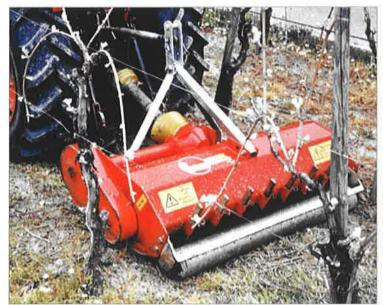
Schmaler und mittiger Schlegelmulcher DS mit untenliegendem Getriebe
