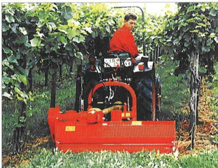
Extrem kurzer Aufbau durch Anordnung des Getriebes hinter der Mitte
