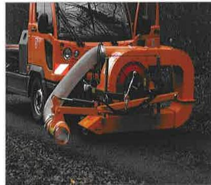
Spezialausführung mit Schlauchanschluss am Multicar - Fumo
