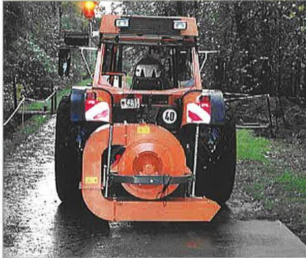
Eine regelmäßige Reinigung optimiert das Ergebnis. Ein großer Vorteil dieser Ausführung liegt darin, dass der Wegrand scharf ausgeblasen wird und das Bankett von organischen Abfällen gereinigt wird. Dadurch baut sich das Bankett weniger auf und muss weniger abgehobelt werden. Der Wasserabfluss wird verbessert.
